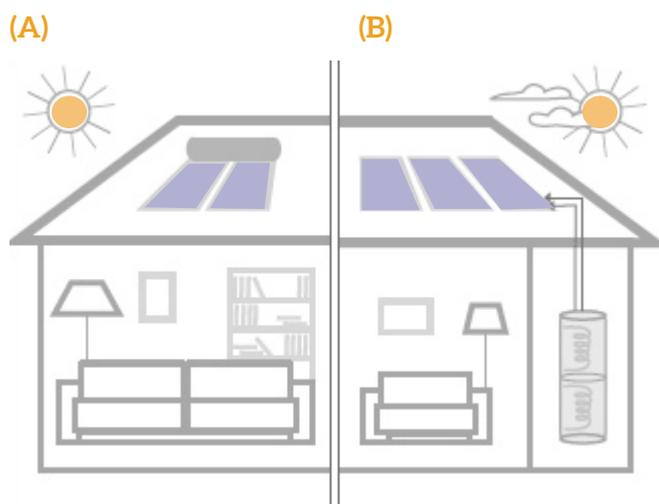
Nel **sistema a circolazione naturale** il serbatoio di accumulo dell'acqua calda è posizionato sul tetto, più in alto rispetto ai pannelli. Quando il fluido contenuto all'interno dei pannelli (collettori) si scalda, esso diventa più leggero e si dirige automaticamente verso il boiler (circolazione naturale).
